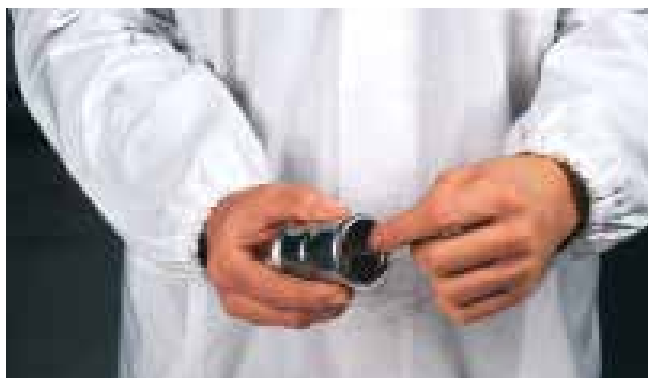
Obr. 30 – Kontrola těsnicího kroužku
