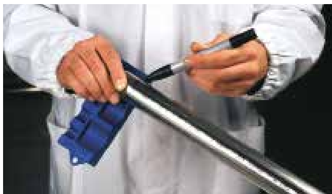
Obr. 28 – Označení hloubky zasunutí
